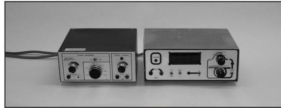
Le CTP propose un générateur de tensions continues et alternatives (de 0,2 Hz à 22 kHz) avec fréquencemètre intégré (ET 2000 24216) ou un générateur de tensions continues et alternatives (de 90 Hz à 10 kHz) associé à un fréquencemètre séparé (EE 2000 34223 associé à EA 3300 33285).
