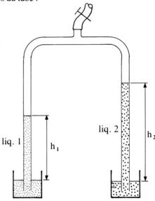
La pression exercée sur la surface libre des deux liquides étant la pression atmosphérique et la même pression régnant au-dessus de chacune des deux colonnes, on a :
